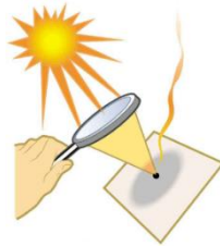
Figura 3.15.9. La luz solar enfocada por una lupa convergente puede quemar papel. Los rayos de luz del sol son casi paralelos y cruzan en el punto focal de la lente. Cuanto más potente sea la lente, más cerca de la lente cruzarán los rayos.
