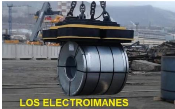
Figura 3.8.7. Un electroimán alzando una pesada carga
