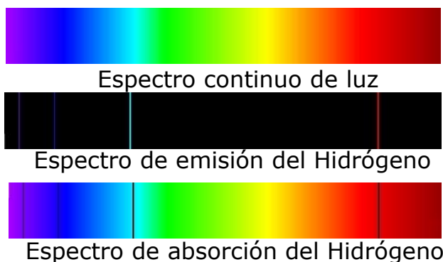
3.15.25. El espectro de emisión de un elemento es el negativo del espectro de absorción: a la frecuencia a la que en el espectro de absorción hay una línea negra, en el de emisión hay una línea emitida, de un color, y viceversa.
